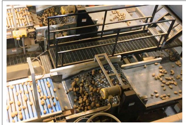
FIG. 11 SIZING SYSTEM (TYPICAL)
