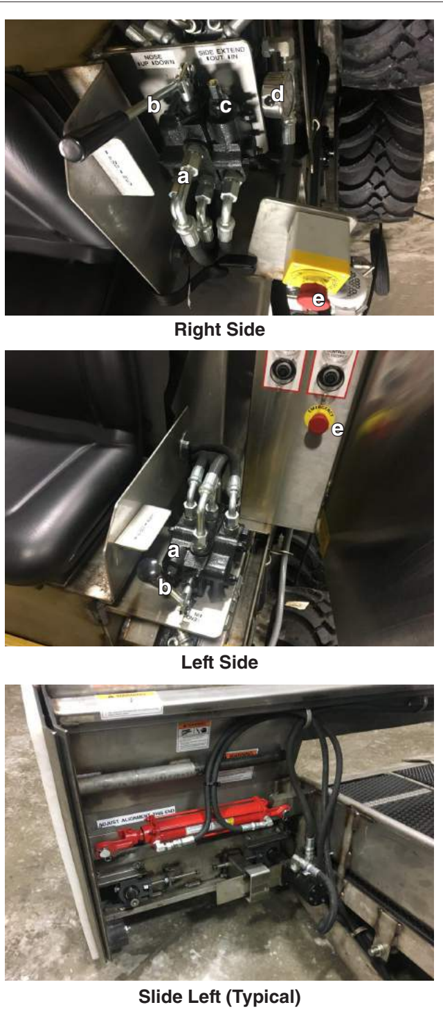
FIG. 11 VAN UNLOADER CONTROLS
